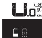
Werden an einem eBike mit zwei eingesetzten Akkus beide Akkus am Fahrrad geladen, so wird auf dem Display der Ladefortschritt der beiden Akkus angezeigt (in der Abbildung wird gerade der linke Akku geladen). Welcher der beiden Akkus gerade geladen wird, können Sie auch an der blinkenden Anzeige am Akku erkennen.
